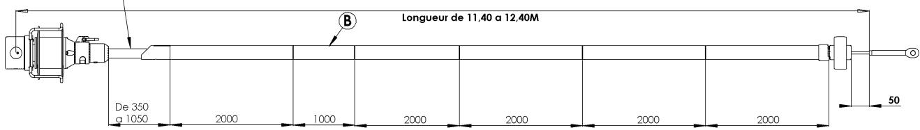
**CAS n°2** : votre étai est compris entre 11,40 et 12,40 mètres, vous avez besoin du tube de un mètre (**Rep. B**). Ce dernier se positionne au-dessus du dernier profil de deux mètres.
