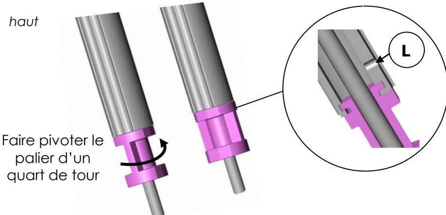
Assembler un palier au-dessous du tube télescopique, le côté mâle vers le haut. Introduire le palier dans le tube télescopique et le tourner d'un quart de tour.
