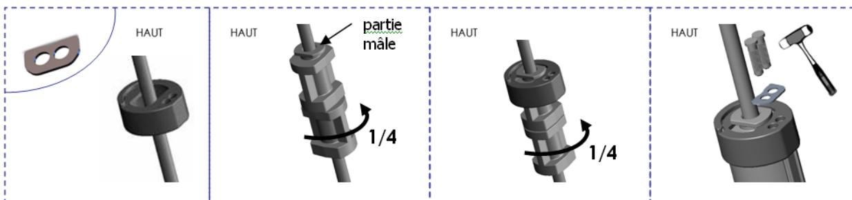
4.2.1- Enfiler la plaque inox puis le bouchon autour de l'étai. Bloquer la plaque en la glissant dans les encoches du bouchon prévues à cet effet.
