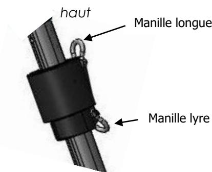
Respecter le sens d'introduction du curseur émerillon. Fixer les deux manilles. Pour hisser les profils le plus haut possible nous vous conseillons d'enfiler le curseur émerillon et monter l'ensemble à l'aide d'une drisse.
