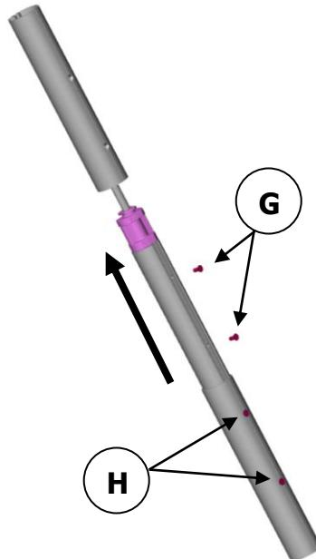
Le profil haut est en place. Assembler un palier autour de l'étaï. Enfiler le profil suivant équipé préalablement de son manchon (cf préparation des profils p.4), avec le manchon orienté vers le haut de l'étaï. A l'aide du manchon, introduire le palier dans le profil supérieur, jusqu'à faire coïncider les perçages du manchon avec ceux du profil supérieur.
