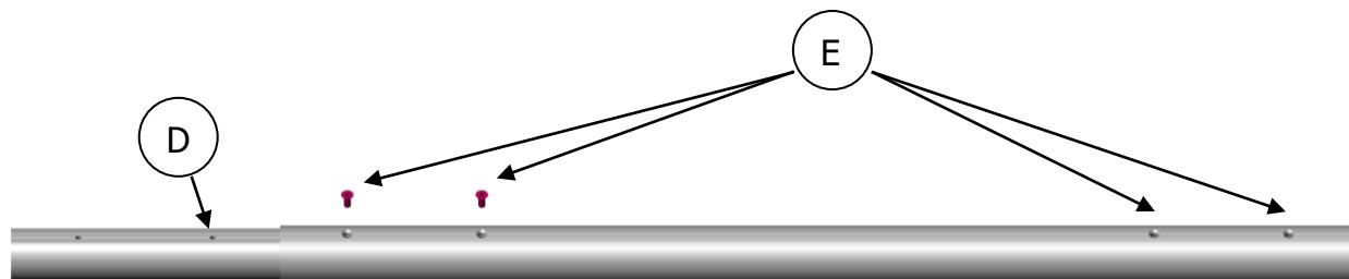
Afin de faciliter le montage, préparer les profils : à savoir, fixer un manchon (Rep. D) sur chaque profil externe sauf sur un, qui sera le profil haut. Tous les profils externes, **y compris le tube haut\***, ont des perçages symétriques à chaque extrémité (Rep. E).
