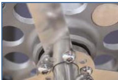
Repérez sous le guide les trous coïncidant avec ceux de la rondelle taraudée.
