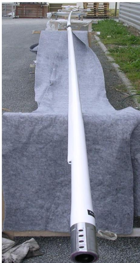
Placer les profils sur des cales en bois, sur un établi ou sur des traiteaux de taille identique
